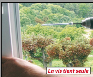
1. Grâce à son empreinte 6 pans, la vis top tient seule sur l'embout 6 pans.
