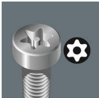
Conçu pour empêcher le dévissage non autorisé de vis dites "de sécurité". Afin de proscrire l'emploi d'outils TORX® "normaux", ces vis sont munies dans leur profil d'entraînement d'une goupille faisant saillie. Celle-ci pénètre dans l'alésage des outils TORX® B0, permettant le desserrage des vis. Ce type de vis de sécurité se retrouve notamment sur de nombreux appareils électriques dont le démontage ou l'entretien doivent être réservés à des techniciens dûment formés.
