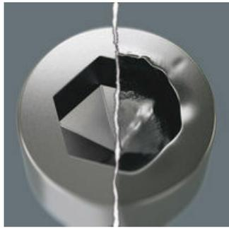
Le problème des vis à six pans creux tient à la minceur des surfaces d'appui sur lesquelles s'opère la transmission de force depuis l'outil. Résultat : la tête de vis peut être détruite. Les outils Hex-Plus possèdent des surfaces d'appui plus larges qui empêchent les têtes de vis de s'arrondir. Bon à savoir : les outils Hex-Plus rentrent dans tous les modèles de vis à six pans creux standard !
