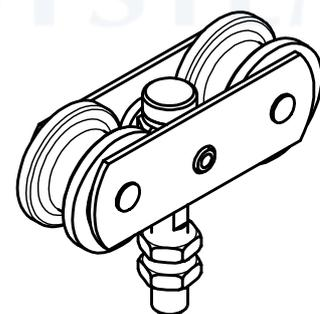
Monture pivotante avec 2 galets delrin sur cages à rouleaux.
