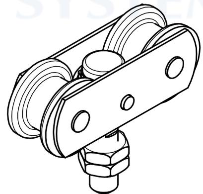
Monture pivotante avec 2 galets delrin sur cages à rouleaux.
