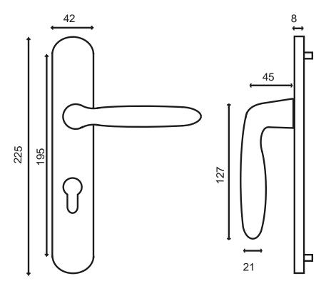
Ressort de rappel sauf sur plaque Cylindre avec piliers Carré de 7 et visserie fournis pour portes de 40mm d'épaisseur
